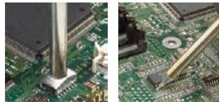
Le fer à souder pour panne-cartouche utilise des cartouches de petit diamètre pour les accès difficiles et dispose d'une large gamme pour la réparation CMS.
