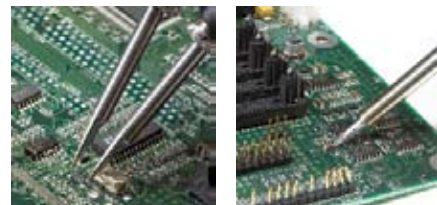
La pince de précision répare des composants CMS grâce à sa dimension réduite mais aussi grâce à des géométries de lames larges, tandis que le fer à souder pour panne dispose d'une puissance exceptionnelle pour le soudage industriel.
