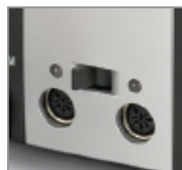
Double sortie commutable
