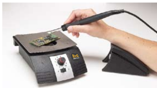
Réparation de petits PCBs directement sur le PCT-100
