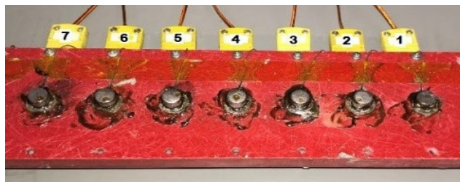
图 1b: 焊点连续焊接测试夹具
