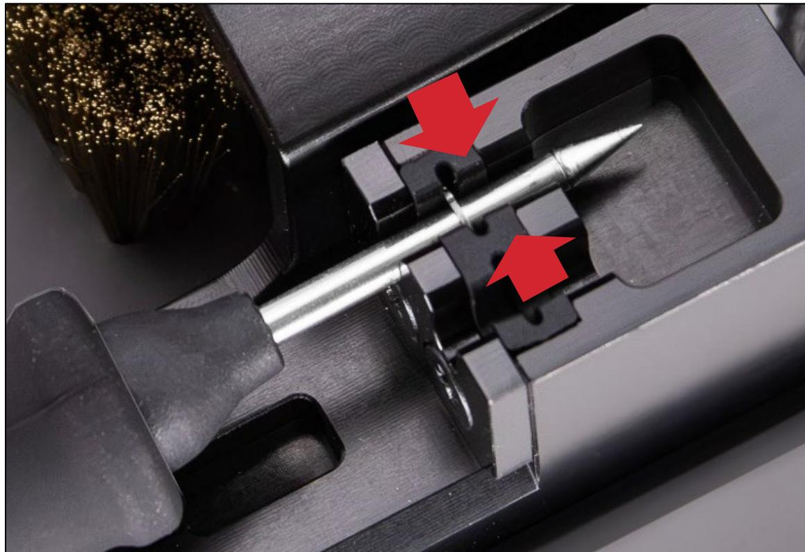
小心地将手柄向后拉，将墨盒安全地留在拆卸工具中。拉动时可能需要用另一只手稳定工作台。
