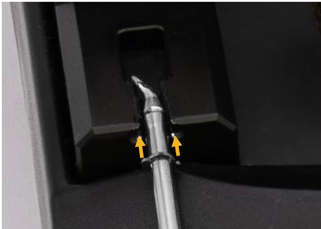
将焊嘴牢固地放入对齐工具中，沿所需方向缓慢旋转镊子，直到焊嘴处于所需位置。
